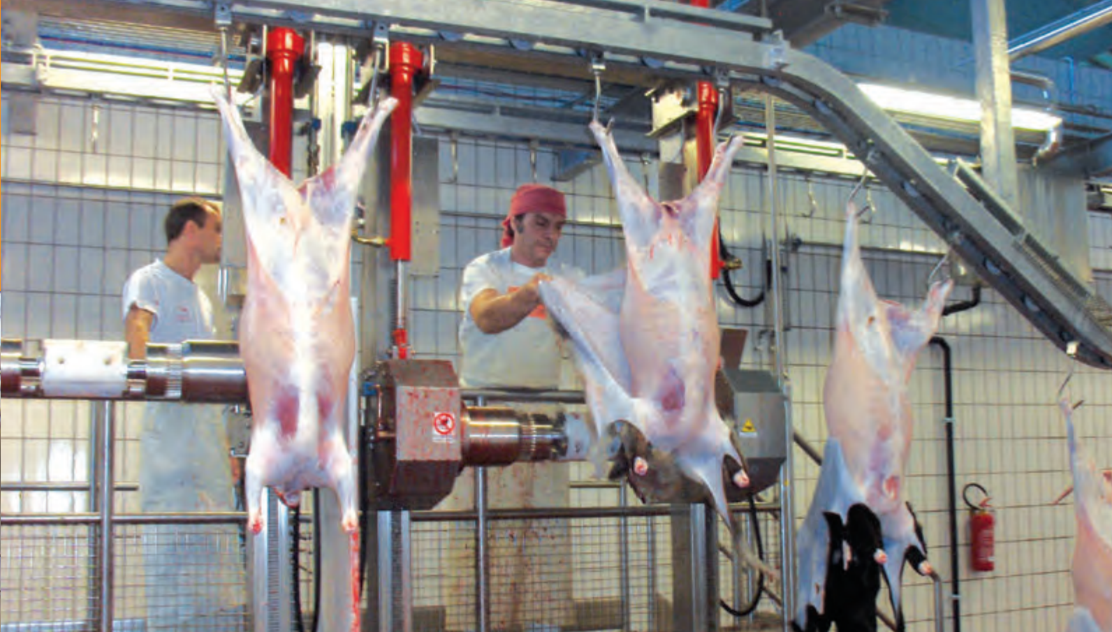
Sistema di scuoiatura ovini in linea, cap.300 capi/h. - Skinning machine for sheep cap.300 heads per hour
