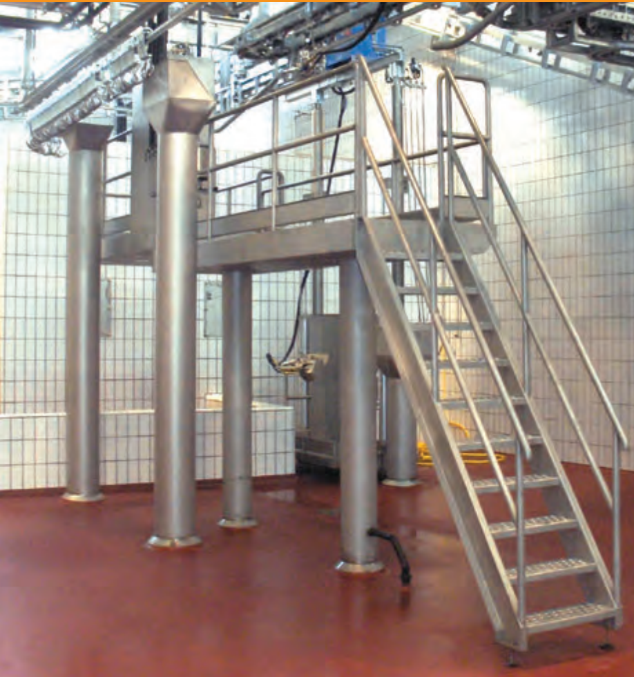
Pedana fissa di trasferimento e taglio corna/zampe - Fixed platform for transfer and horn/legs cutting
