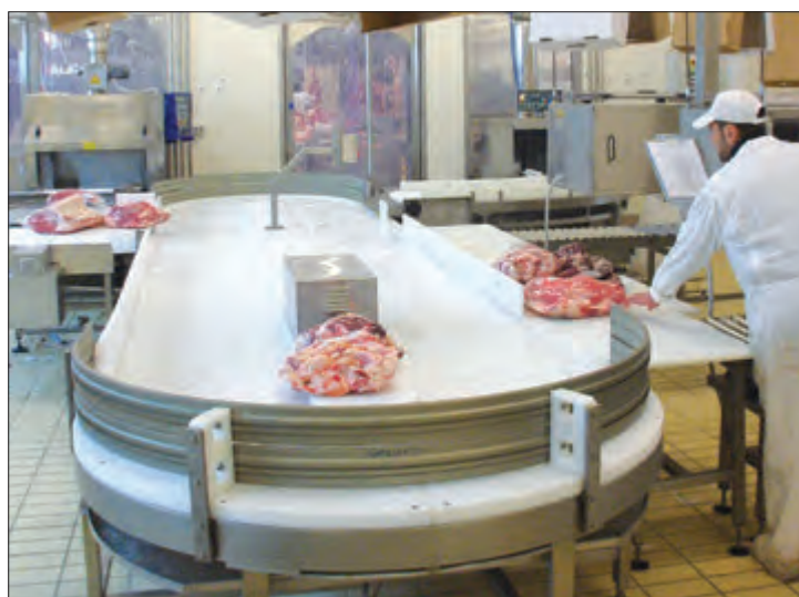
Giostra di selezione tagli anatomici Rotating conveyor for meat selection
