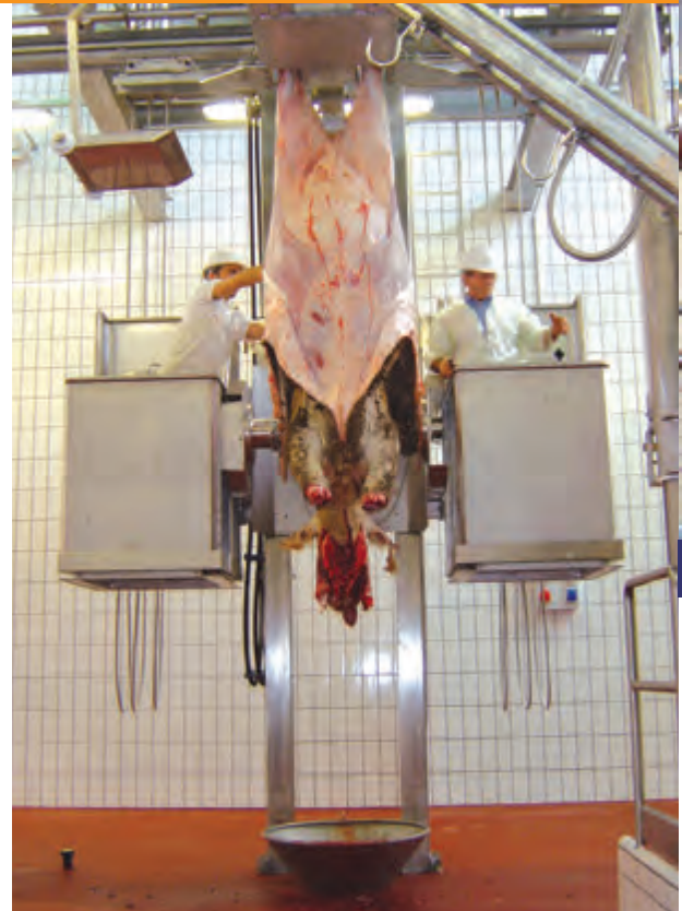
Macchina strappapelle bovini cap.70 capi/h. - Cattle dehider cap.70 heads per hour
