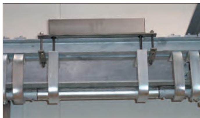
Bilancia aerea con celle di carico Aerial scale with load cells
