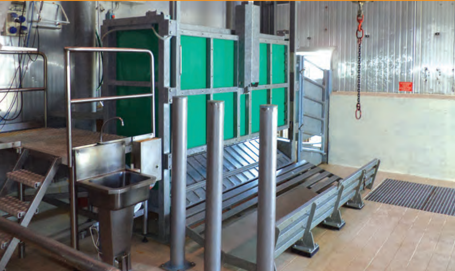
Trappola di abbattimento bovini tradizionale - Christian killing box
