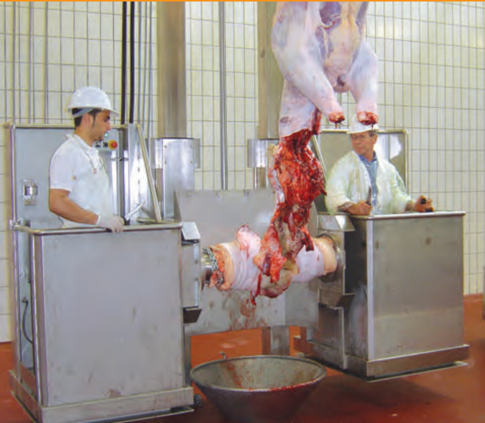
Macchina strappapelle bovini cap.70 capi/h. - Cattle dehider cap.70 heads per hour
