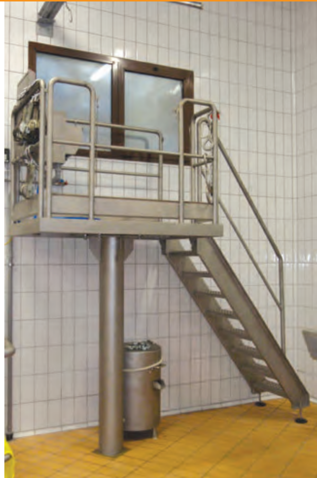
Pedana fissa di trasferimento e taglio corna/zampe - Fixed platform for transfer and horn/legs cutting
