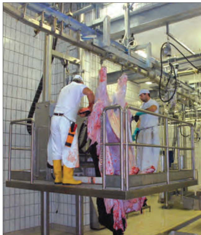
Pedanone di scuoiatura per impianti bovini a ridotta capacità Skinning platform for low capacity cattle slaughterhouses
