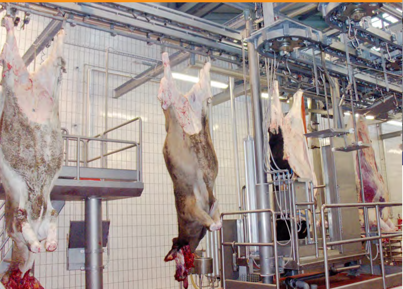
Catena di macellazione bovini - Slaughtering conveyor for cattle
