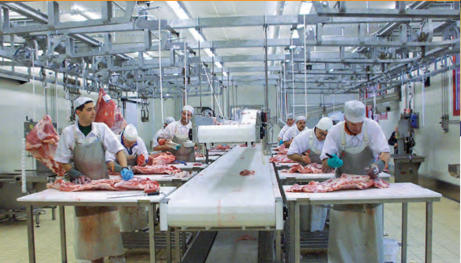
Tavolo da disosso a 16 postazioni, completo di nastri aggiuntivi per trasporto ossa e grassi Deboning conveyor with 16 platforms, additional belts for bones and fat transport and supporting steel structure
