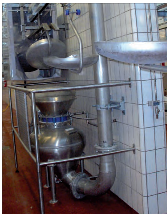
Cannone pneumatico di sparo visceri Pneumatic blow gun for viscera
