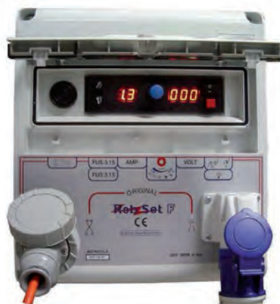
Storditore suini a mezzo elettroshock Pig stunner through electroshock
