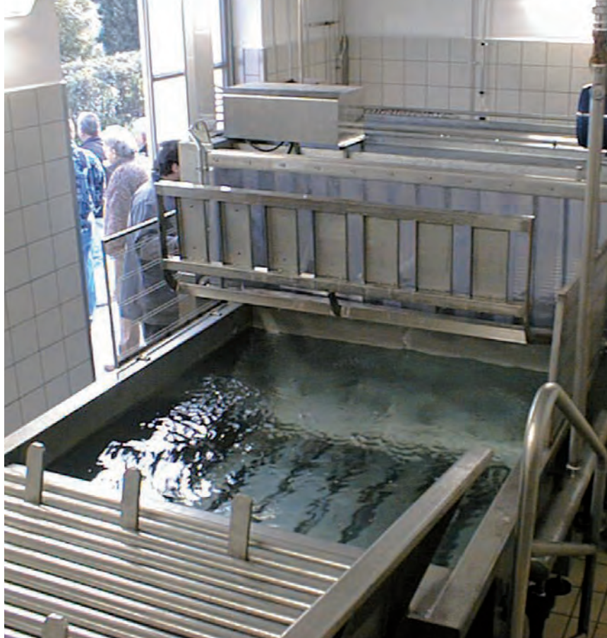
Vasca di scottatura suini per piccole produzioni Pig scalding tank for small production
