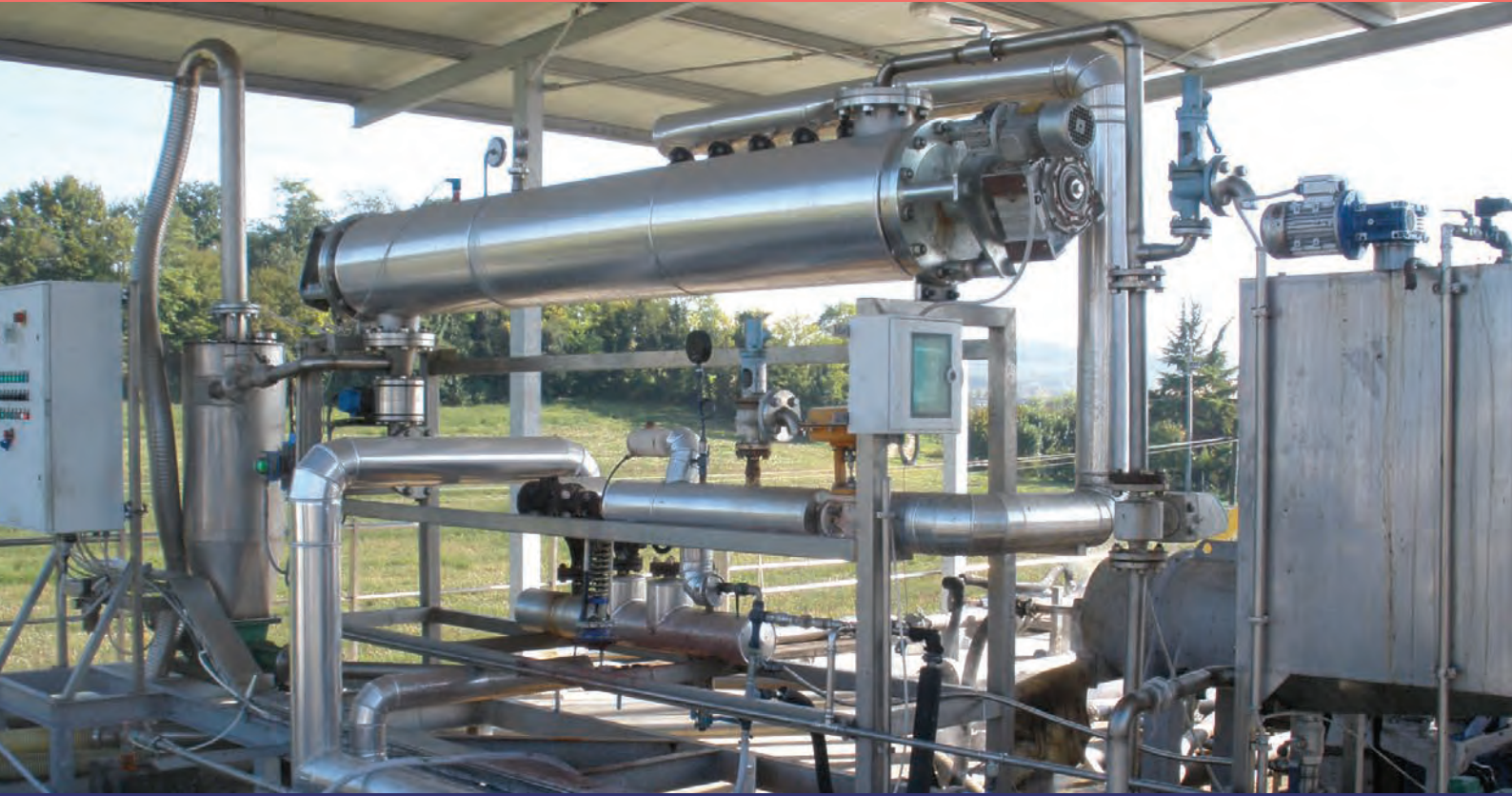
Sistema di coagulazione e sterilizzazione del sangue animale Blood coagulator and sterilization unit
