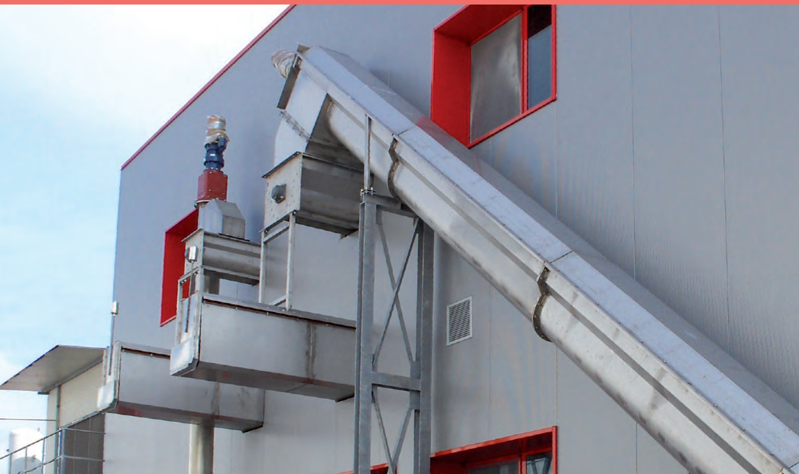
Vasconi di raccolta ossa e grassi con scarico esterno Tank for bones and fat collection with external output and truck loader
