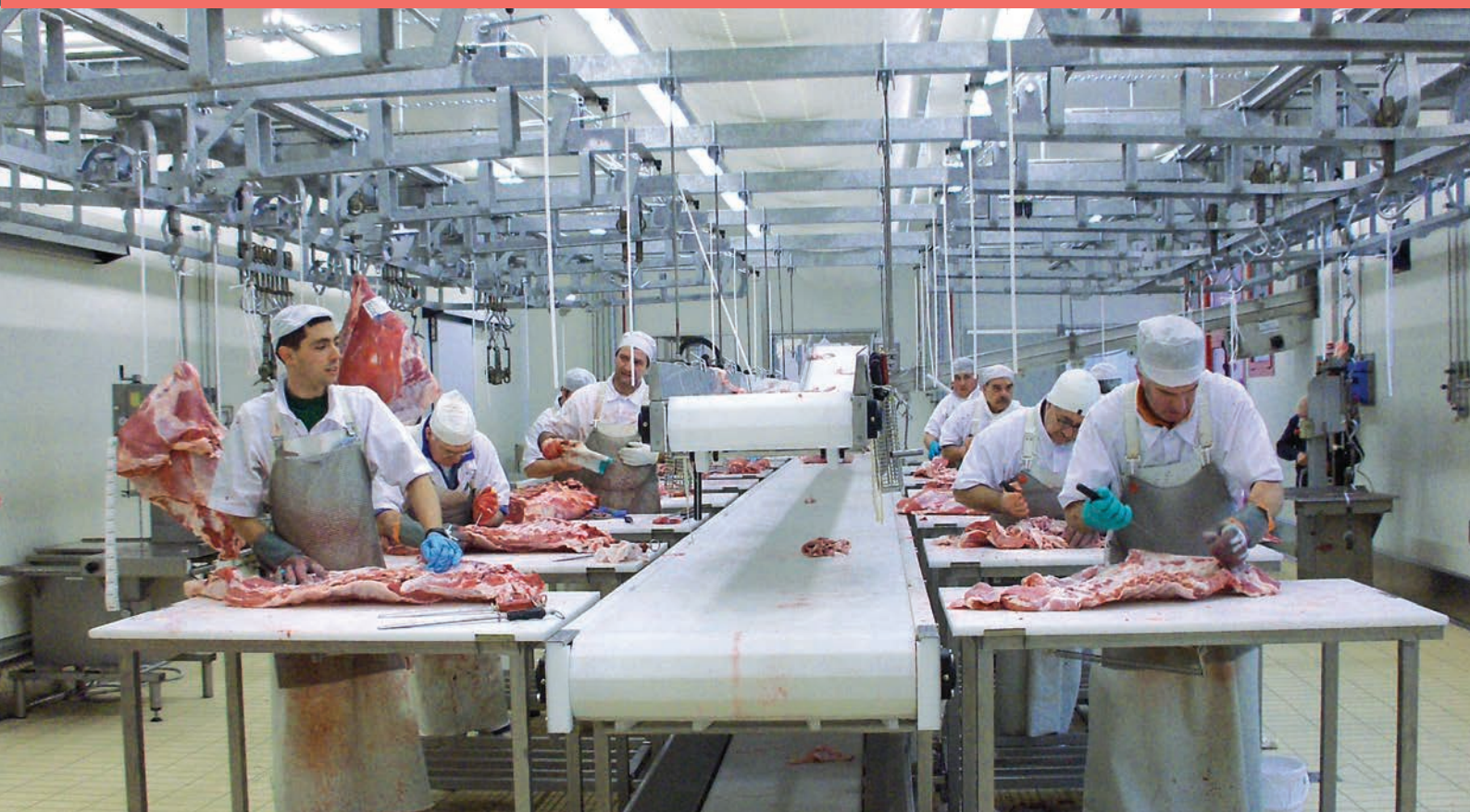
Tavolo da disosso a 16 postazioni, completo di nastri aggiuntivi per trasporto ossa e grassi Deboning conveyor with 16 platforms, additional belts for bones and fat transport and supporting steel structure
