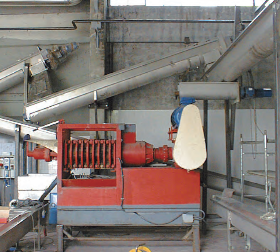
Impianto di trasformazione sottoprodotti della macellazione e produzione farine animali Rendering and Meat Bone Meal production plant
