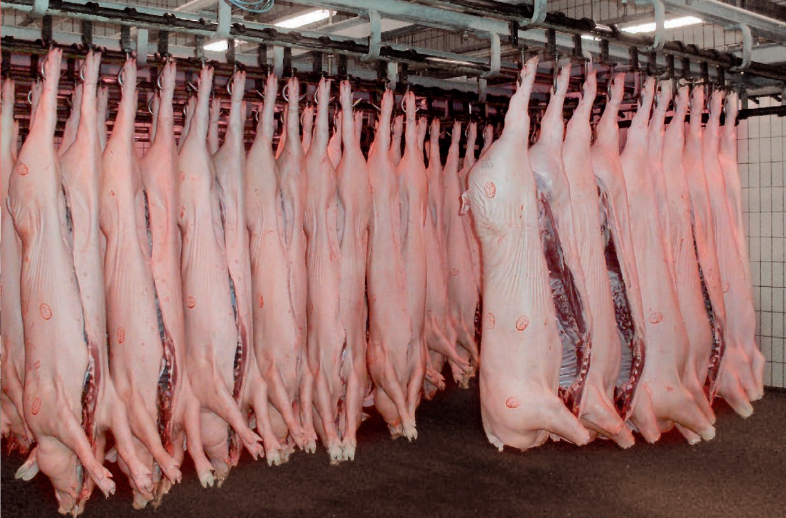
Zona spedizione con guidovia in tubo D2" Delivery area with tubular rail D2"
